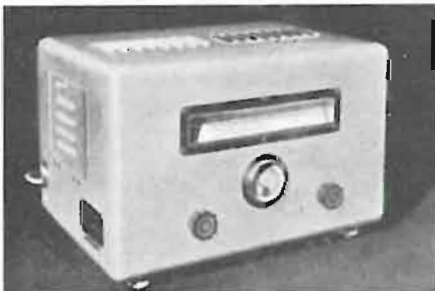
Aspetto esterno dell'umidimento a lettura diretta. Al centro è il voltmetro di controllo della tensione applicata al tubo a raggi infrarossi. In alto la scala traslucida graduata direttamente in percentuale di umidità.
